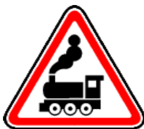
1.2 Железнодорожный переезд без шлагбаума
